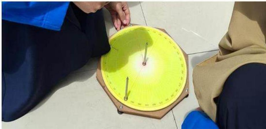
Gambar 5. Proses keenam adalah pemasangan benang pada alat ukur. Setelah benang terpasang, benang tersebut dibentangkan mengikuti arah kiblat yang telah ditentukan. Benang tidak ditarik terlalu kencang, melainkan dibiarkan sedikit kendur agar tetap stabil.
