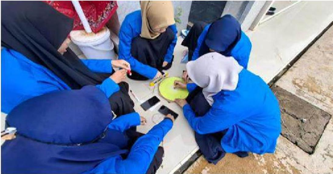
Gambar 3. Proses menyeimbangkan alat ukur Proses keempat adalah menyeimbangkan arah kiblat dengan menggunakan alat bantu berupa water pas yang dilengkapi cairan gelembung. Alat ini digunakan untuk memastikan alat ukur arah kiblat berada dalam posisi rata dan sejajar, yaitu rata 1, rata 2 dan rata 3.
